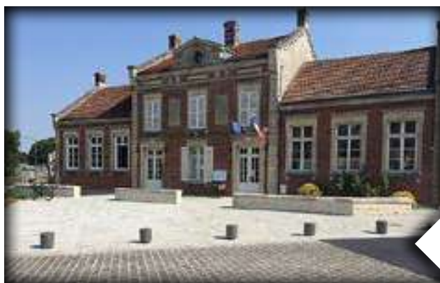
L'ensemble de la place est traité avec un matériau unitaire : par exemple des pavés de grès brut sur la route et des pavés taillés pour l'espace piéton. Des bornes protègent l'espace piétons. Exemple à Pontarmé (60)
